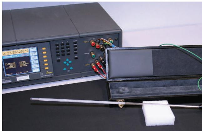
Эталонный термометр (SPRT, термометр сопротивления платиновый), калиброванный по ITS90
